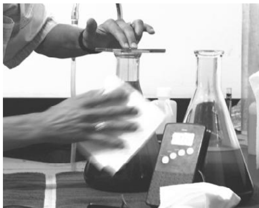
Figura 735 - 7. Secado de la placa de vidrio y del exterior del matraz
