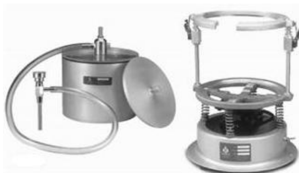
Figura 735 - 1. Picnómetro de vacío y dispositivo de agitación
